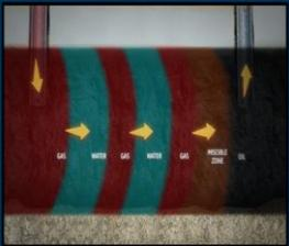
Injeção alternada de água e gás auxiliando na recuperação do óleo retido no reservatório
